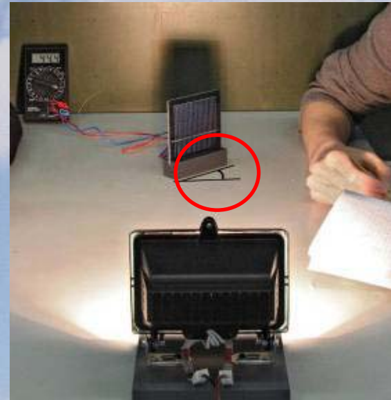
Solarzellen gedreht Winkel : 20^\circ - Fotostrom 444 mA
