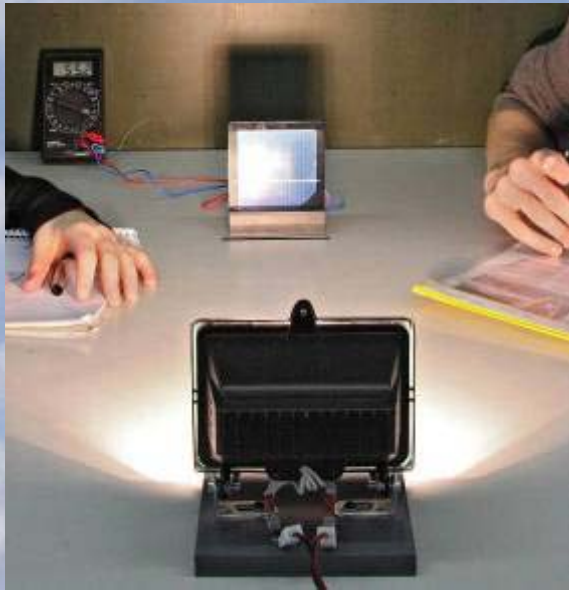
Solarzelle senkrecht zum Licht Winkel : 0^\circ - Fotostrom 552 mA
